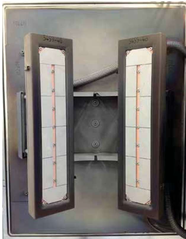
Zwei der im Projekt HIPERCUT entwickelten Titan-Aluminium-Zirkon-Rechtecktargets
